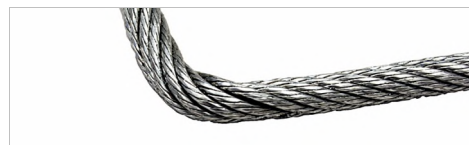
V laně je záhyb. Vzniká násilným vnějším působením síly na lano.
