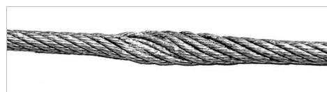
Lano je na jednom místě zploštěné. Tento jev vzniká při stlačení lana.
